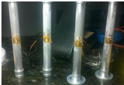
Figura 1 – Extensômetros colados na barra dos sensores.
